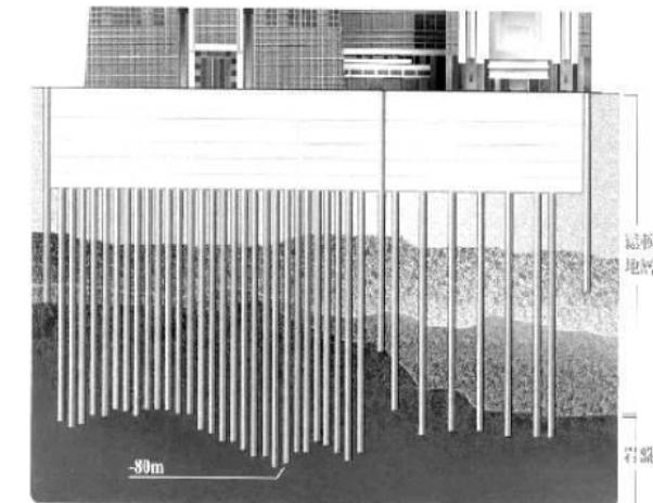
台北101打地基的工程總共進行了15個月，挖出70萬噸土，基樁由382根鋼筋混凝土樁構成。中心的巨柱為雙管結構，內管內灌入混凝土，巨柱焊接花了約2年的時間完成。台北101所使用的鋼至少有5種，依照不同部位所設計，特別調製的混凝土，比一般混凝土強度強60%。
